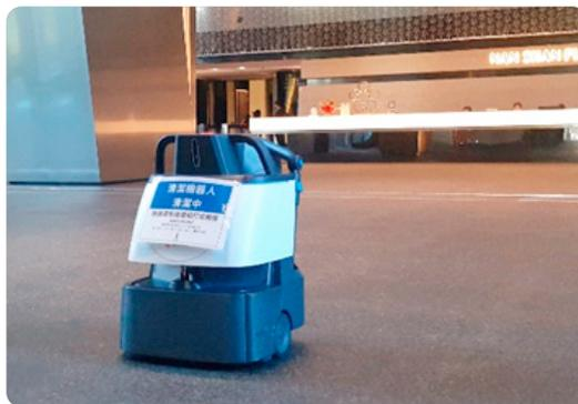
台北南山広場では、オフィスフロアにおける環境負荷低減を目的に、ゴミ計量と清掃ロボットを導入しました。リサイクル率の低いテナントには営業担当が分別協力を呼びかけ、掲示物や案内配布を通じて意識向上を図っています。また清掃ロボットはIRIS製を採用し、台湾オフィスビルでの導入第一号として当社のノウハウを海外展開しています。均一的な床清掃により品質を維持しつつ、清掃時間の効率化でビル全体の清掃品質向上にも貢献しています。
